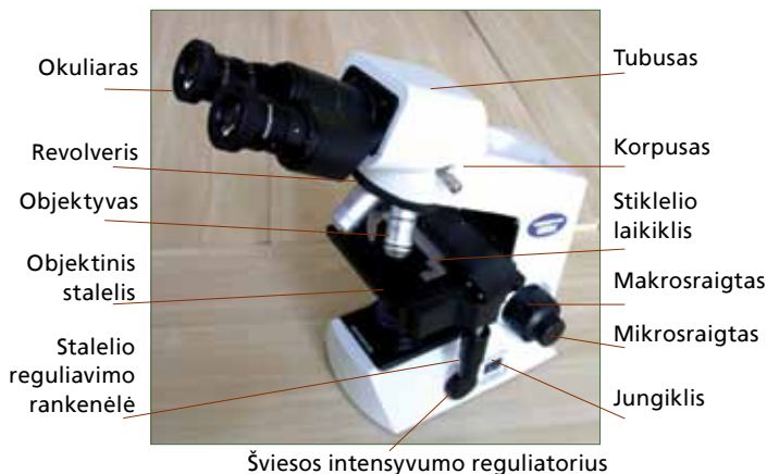
2 pav. Šviesinio mikroskopo Olympus CX22 bendras vaizdas (E. Kutorgos nuotrauka)
