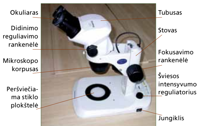
1 pav. Stereoskopinio mikroskopo Olympus SZ51 bendras vaizdas (E. Kutorgos nuotrauka)
